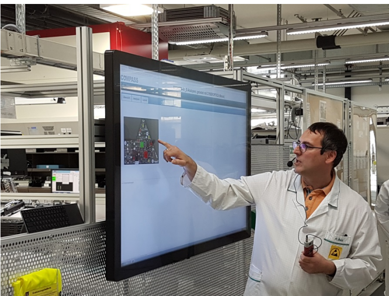
COMPASS zeigt im Originalfoto der Baugruppe vorhandene Fehlerschwerpunkte
